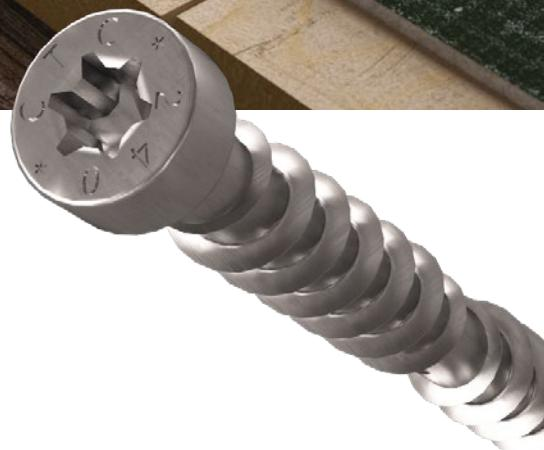
CTC es el conector para forjados de madera-hormigón. Certificado CE, permite conectar una losa de hormigón de 5 o 6 cm a las vigas de madera del forjado subyacente y obtener una nueva estructura de madera-hormigón con una resistencia extraordinaria y unas óptimas prestaciones estáticas y acústicas. Sistema homologado, autoperforante, reversible, rápido y no invasivo.
